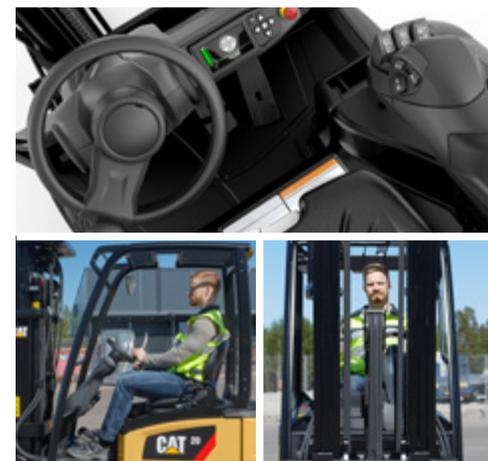
Il sedile e il piantone dello sterzo regolabili assicurano una posizione di guida perfetta per operatori di qualsiasi corporatura. La visibilità anteriore, laterale e verso il basso è eccellente grazie al particolare design della struttura del cilindro di sollevamento con tubazioni e catene posizionate in modo da ostacolare il meno possibile la visuale. I comandi ergonomici comprendono un bracciolo regolabile, con leve a sfioramento integrate, e un set di pedali che non affaticano.
