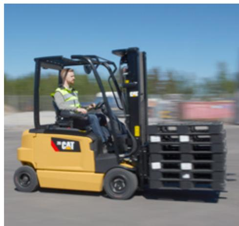
Il sistema di guida sensibile (Responsive Drive System - RDS) reagisce istantaneamente al cambiamento di velocità dei movimenti del pedale, facendo in modo che tutte le azioni siano controllate in modo progressivo, comprese le curve, gli avvisi e gli arresti.
